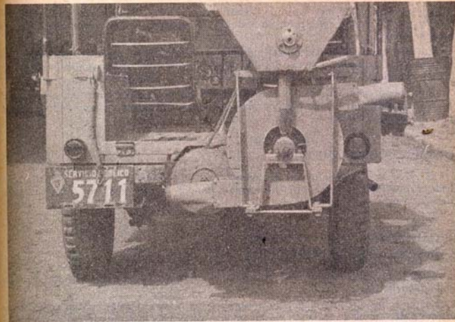
Máquina esparcidora de cebo tóxico acoplada a un "Jeep" y movida por su polea
